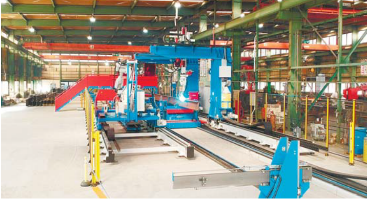
全自動梁組み立て溶接ロボット「SBA」
