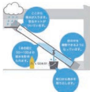
立体駐車場の柱の中に雨水が貯められる「雨水貯留柱」を開発しました。非常災害時の水の確保や、清掃用の水まきに利用できます。
