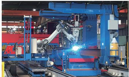
生産性向上と将来の人財不足への対応を目的として、2019年に鉄構工場へ梁鉄骨の組立・溶接を自動で行うロボットを導入しました。運用効率化を図り、より一層の生産性向上を目指していきます。
